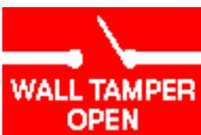
Apparaît lors de l'ouverture de la vis de l'interrupteur de sécurité mural. Ce message apparaîtra également à la fin de la séquence de mise sous tension, si la vis de l'interrupteur de sécurité mural est ouverte pendant la mise sous tension. Le détecteur entre dans le mode menu après la fin de la séquence de mise sous tension.
