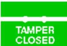
Apparaît lorsque la vis de l'interrupteur de sécurité située au bas de l'unité est fermée correctement. Cela signifie que l'unité est entrée en fonctionnement..
