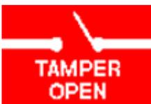
Apparaît lorsque la vis de l'interrupteur de sécurité située au bas de l'unité est ouverte et lorsque les menus ne sont pas accessibles. Ce message apparaîtra également à la fin de la séquence de mise sous tension.
