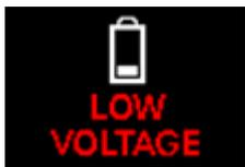
Apparaît dans le mode opérationnel lorsque la tension de l'unité est inférieure à 10 v. Il peut également apparaître après une alarme ou à la fin de la séquence de mise sous tension si la tension est faible.
