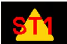
Pour des environnements intérieurs exempts d'animaux de compagnie, SeeTrue™ augmente la détection des schémas de mouvements véritables. En plus des indications normales, SeeTrue™ signale la détection au moyen de l'écran ST1 (texte en rouge sur un triangle jaune). Pour des raisons du relais et de Digiplex, le ST1 est considéré comme une alarme.
