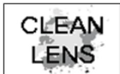
Apparaît dans le mode opérationnel lorsque l'unité détecte une réduction de la transparence de la lentille, c.-à-d. en dessous de 50 % des niveaux réglés par défaut. Si cette condition existe, ce message apparaît à la fin de la séquence de mise sous tension.
