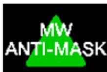
La détection anti-masque à micro-ondes apparaît dans le mode opérationnel après la détection d'un objet en mouvement et après l'écoulement de 90 secondes du temps d'affichage de la notification de l'anti-masque à micro-ondes. Dans le mode d'essai, la détection anti-masque à micro-ondes apparaît instantanément lors de la détection d'un objet en mouvement.
