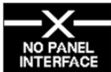
Apparaît dans le mode opérationnel si des câbles de Digiplex sont déconnectés ou non valides. Ce message n'apparaît qu'une seule fois à la fin de la séquence de mise sous tension. Une fois que le bus de Digiplex est raccordé correctement, ce message n'apparaît que s'il est déconnecté ou non valide.
