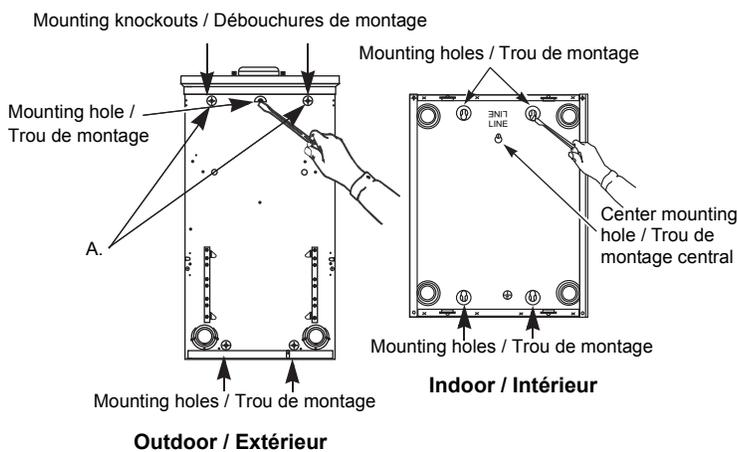
Fig. 4: Flush Mounting / Montage encastré
